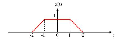
$$\begin{split} x(t) &= (t+2)[u(t+2) - u(t+1)] + u(t+1) - u(t-1) + (-t+2)[u(t-1) - u(t-2)] \\ &= (t+2)u(t+2) - (t+2-1)u(t+1) - (1+t-2)(u(t-1) - (-t+2)u(t-2) \\ &= (t+2)u(t+2) - (t+1)u(t+1) - (t-1)(u(t-1) + (t-2)u(t-2) \\ &= r(t+2) - r(t+1) - [r(t-1) - r(t-2)] \end{split}$$
