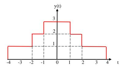
$$y(t) = u(t+4)-u(t+2)+2[u(t+2)-u(t+1)]+3[u(t+1)-u(t-1)]+2[u(t-1)-u(t-2)]+u(t-2)-u(t-4) \\ = u(t+4)-u(t+2)+2u(t+2)-2u(t+1)]+3u(t+1)-3u(t-1)+2u(t-1)-2u(t-2)+u(t-2)-u(t-4) \\ = u(t+4)+u(t+2)+u(t+1)-u(t-1)-u(t-2)-u(t-4)$$
